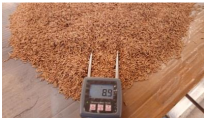
Gambar 8. Pengukuran tingkat kadar air gabah pada box pengering
