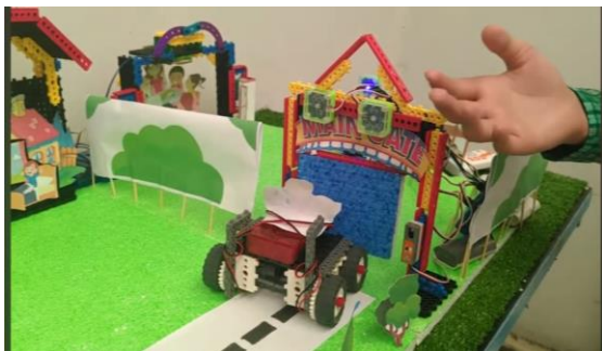
Gambar 2. Robot Disiplin Waktu mendeteksi siswa terlambat masuk ke lingkungan sekolah
