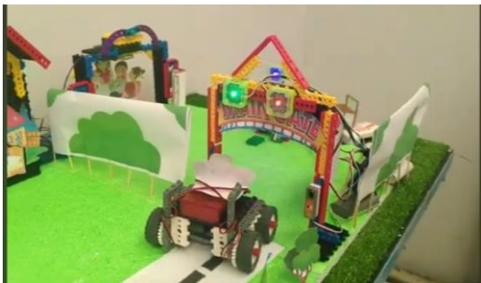
Gambar 1. Robot Disiplin Waktu mendeteksi siswa masuk ke lingkungan sekolah
