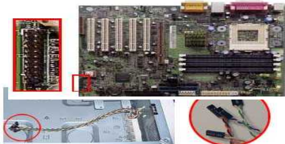
Gambar 2.6 pemasangan kabel pada motherboard
