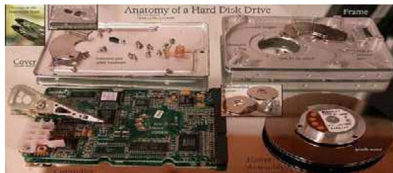
Gambar 3.1 kondisi dalam hardisk
