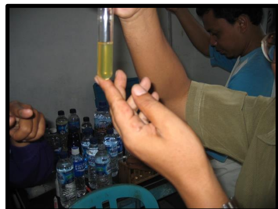
Gambar 7. Sampel air yang positif mengandung N-amoniak
