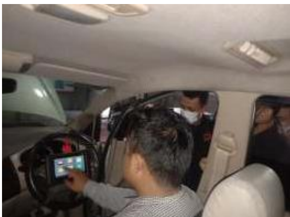
Gambar 6. Demonstrasi penggunaan Scanner pada kendaraan injeksi
