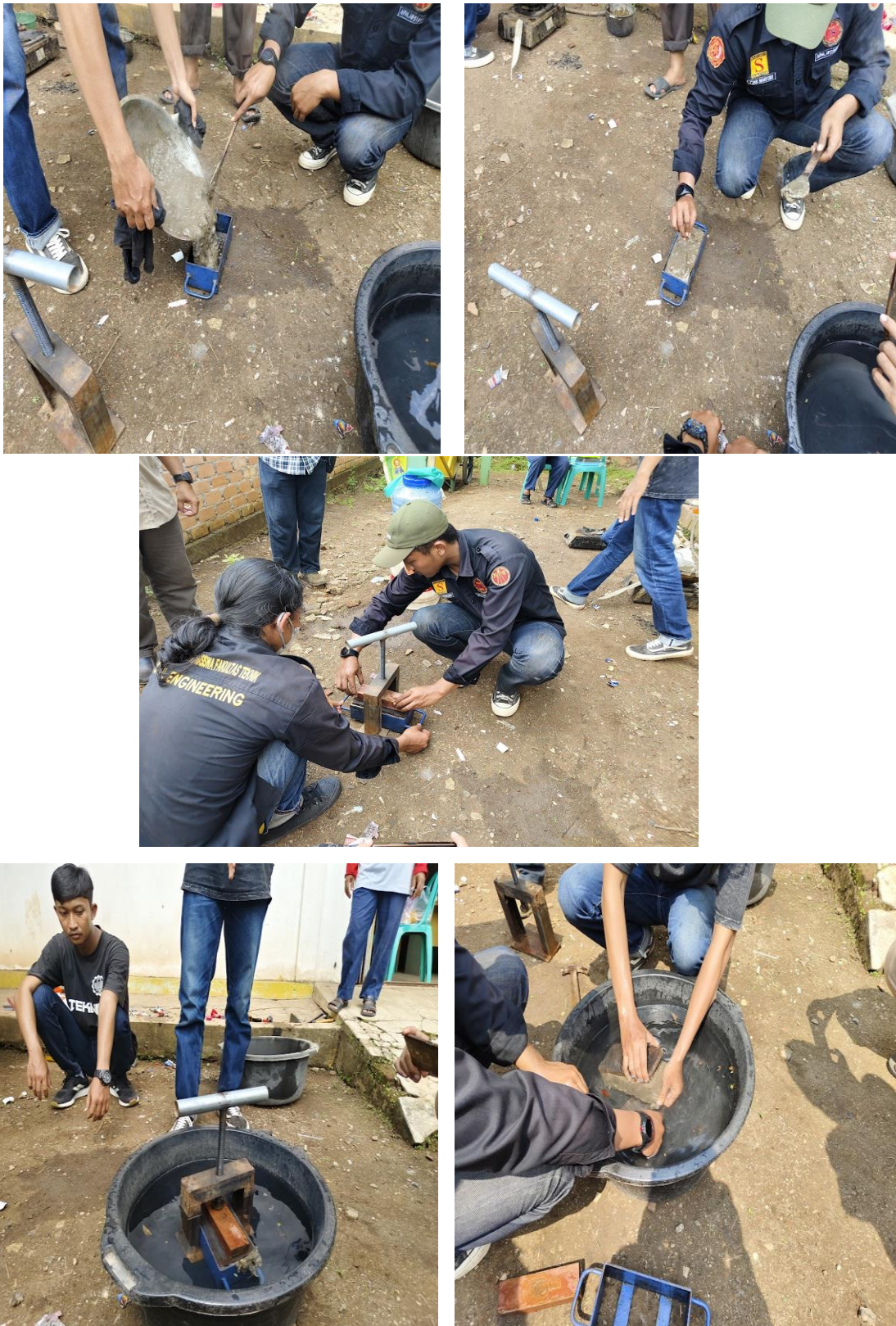
Gambar 6. Tahapan Proses Pencetakan Paving Block Plastik Gambar 6A, 6B, 6C, 6D, dan 6E (Sumber: Tim Abdimas, 2024)
