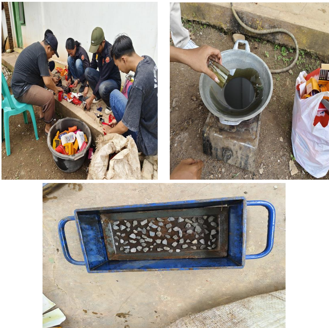
Gambar 5. Tahapan Proses Pembuatan Bahan Baku Cair Paving Block Plastik Gambar 5 A dan 5B, Cetakan Paving Block Gambar 5C (Sumber: Tim Abdimas, 2024)
