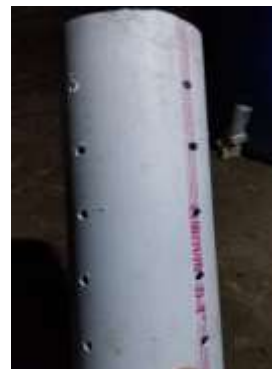
Paralon yang sudah dilubangi
