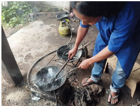
Gambar 4. Tahapan Proses Pembuatan Bahan Baku Cair Paving Block Plastik LDPE, Gambar 4A Proses Pemanasan Oli, Gambar 4B Proses Pelelehan Plastik Gambar 4C Kondisi Plastik Sudah Leleh, 4D Pengukuran Suhu (Sumber: Tim Abdimas Teknik Sipil, 2024)
