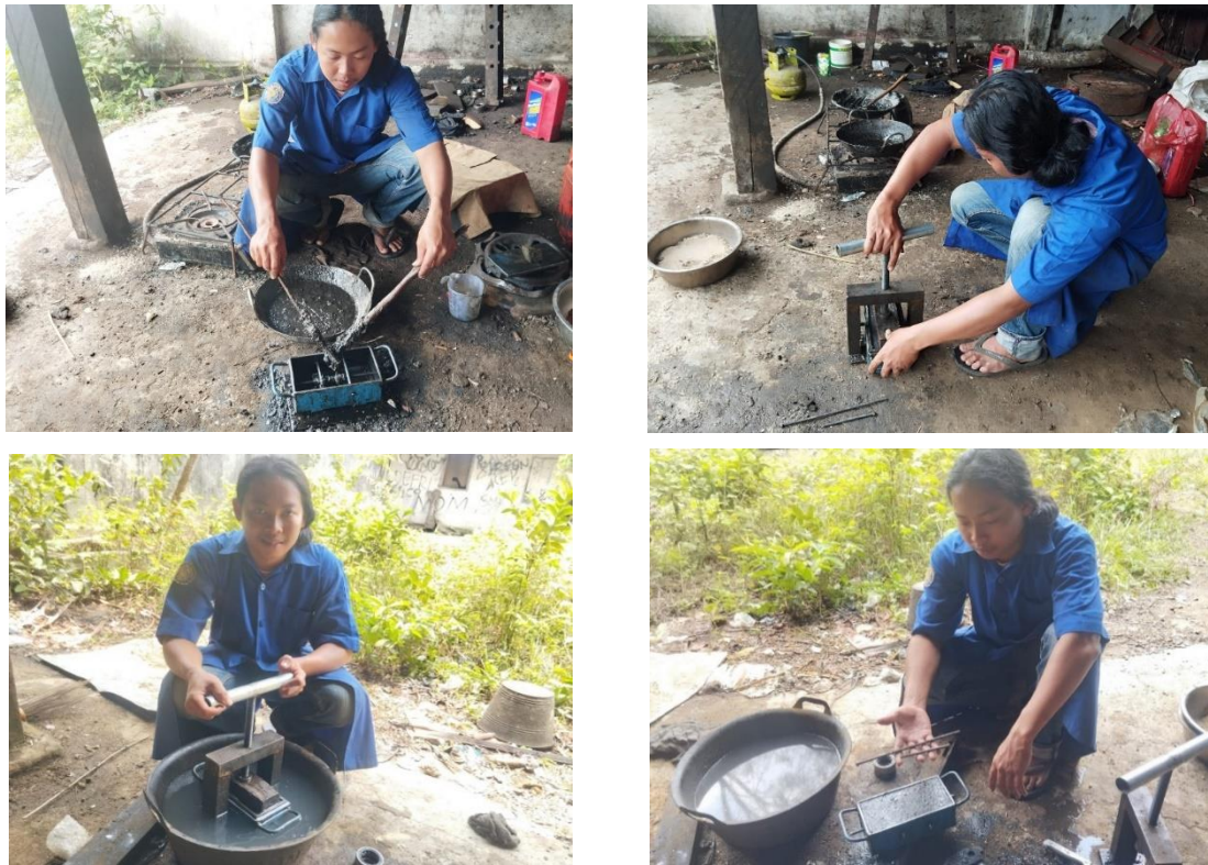
Gambar 5. Tahapan Proses Pencetakan Paving Block Plastik Gambar 5A Proses memasukkan bahan baku ke cetakkan, gambar 5B proses cetak, gambar 5C proses perendaman, dan gambar 5D proses pelepasan kaitan besi (Sumber: Tim Abdimas Teknik Sipil, 2024)
