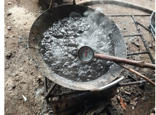
Gambar 4. Tahapan Proses Pembuatan Bahan Baku Cair Paving Block Plastik LDPE, Gambar 4A Proses Pemanasan Oli, Gambar 4B Proses Pelelehan Plastik Gambar 4C Kondisi Plastik Sudah Leleh, 4D Pengukuran Suhu (Sumber: Tim Abdimas Teknik Sipil, 2024)
