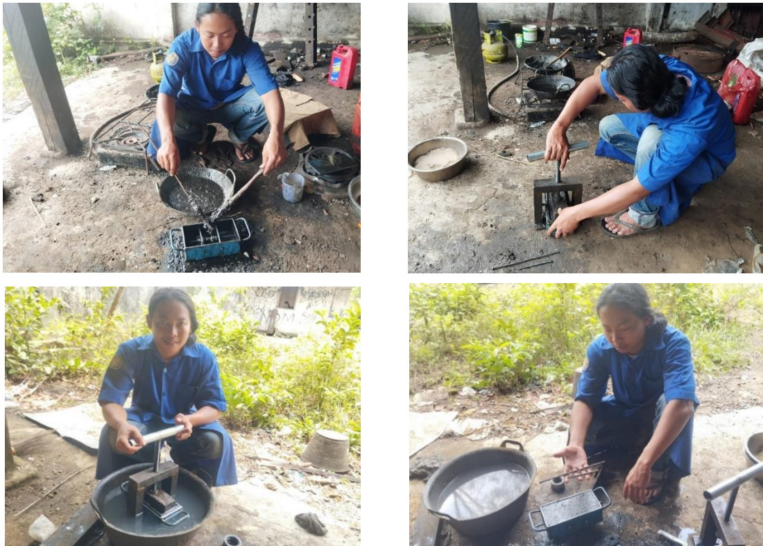
Gambar 5. Tahapan Proses Pencetakan Paving Block Plastik
