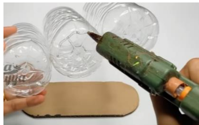
Gambar 3. Penempelan kardus ke bagian bawah botol
