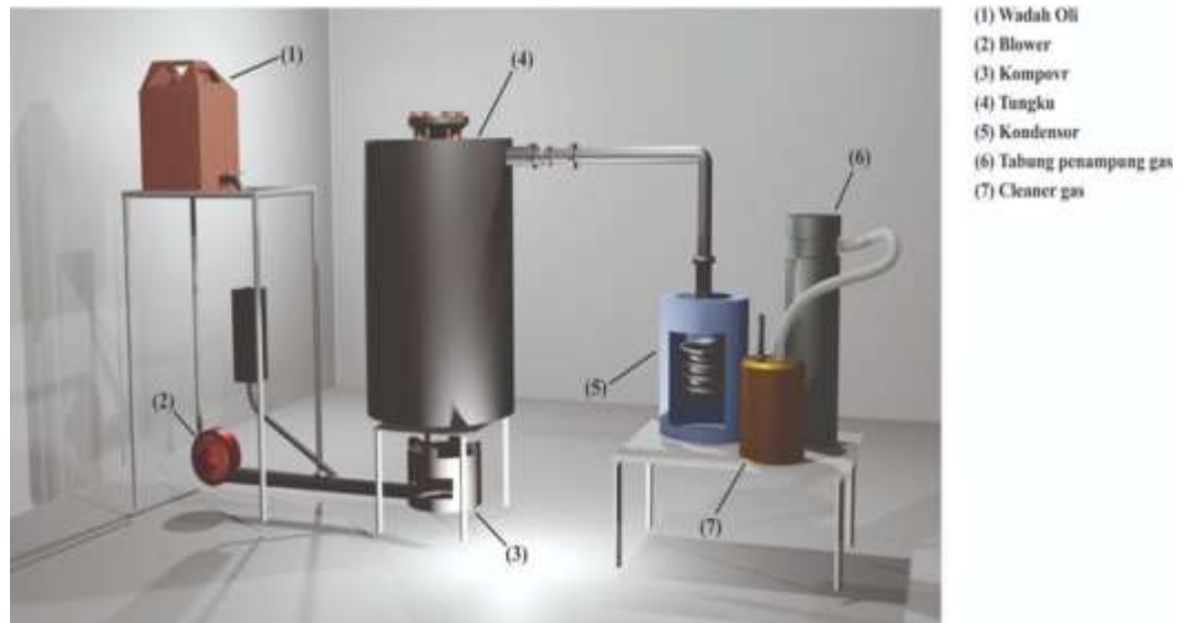
Gambar 3. Seperangkat Reaktor Pirolisis dan Komponen
