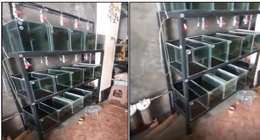
Gambar 7. Hasil Rak Aquarium Bersusun 3 Berbahan Baja Profil
