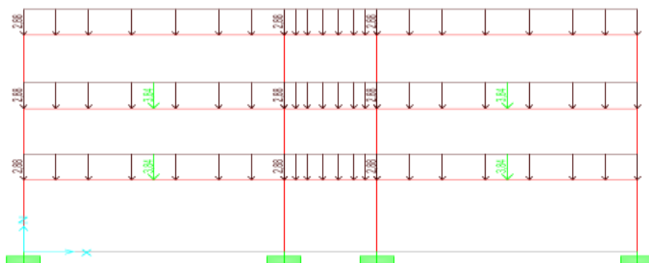
Gambar 7. Input pembebanan balok pada program SAP 2000
