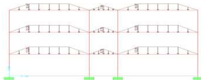
Gambar 4. Input pembebanan Pelat pada program SAP 2000
