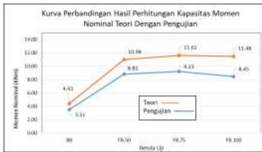
Gambar 11. Kurva Perbandingan Hasil Perhitungan Kapasitas Momen Nominal (Mn) Teori Dengan Pengujian (Sumber: Hasil Penelitian, 2022)
