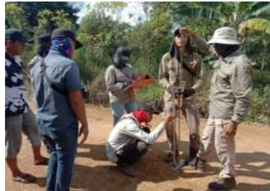
Gambar 5. Penelitian Menggunakan Alat DCP (Sumber: Dokumentasi Penelitian, 2023)
