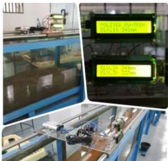
Gambar 6. Percobaan alat pada flume (Sumber: Dokumentasi penulis, 2023)
