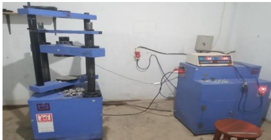
Gambar 11. Alat Uji Kuat Tekan Paving Block (Sumber: Yusuf Amran-Arif Wahyu Permana, 2024)
