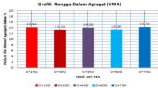
Gambar 25. Grafik hasil rongga dalam agregat (VMA)
