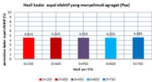
Gambar 20. Hasil kadar aspal efektif yang menyelimuti agregat (Pae) Titik II AMP (Finiser)
