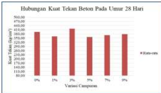
Gambar 4. Grafik Hubungan antara Semua Variasi Campuran vs Kuat Tekan pada Umur 28 Hari
