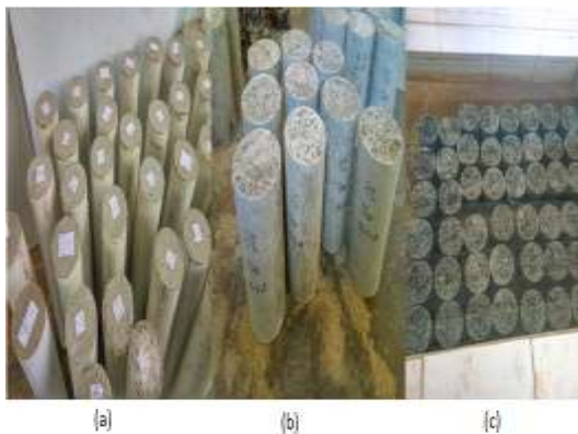
Gambar 2. Benda Uji Beton : a). Benda uji sebelum dipotong ; b). Benda uji setelah dipotong ; c). Proses curing
