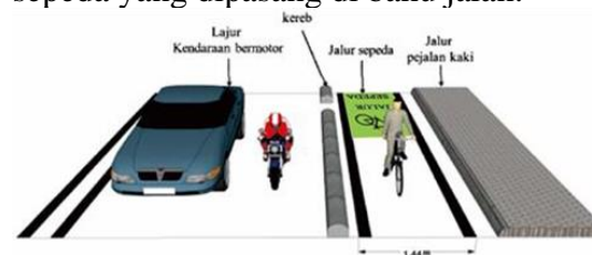
Gambar 1. Perspektif jalur sepeda satu arah Tipe A di badan jalan. (Pedoman Perancangan Fasilitas Pesepeda PPFJP, 2021)
