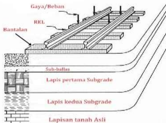
Gambar 1. Struktur Jalan Rel (Sumber : Sri Atmaja P. Rosyidi, 2005)
