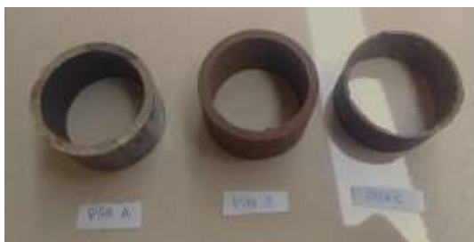
Gambar 1. Pipa A merupakan pipa yang belum digunakan. Sampel penelitian berupa pipa B dan C yang masing-masing merupakan pipa dengan pemakaian 107 hari dan 570 hari.
