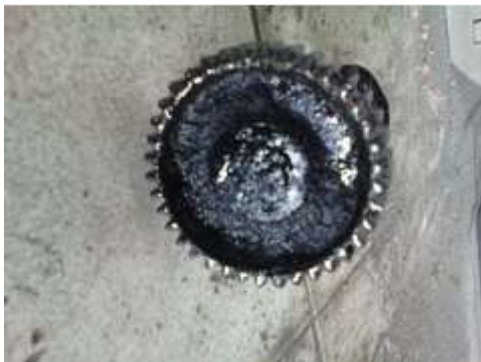
Gambar 7. Hasil pengecoran roda gigi mesin tenun dengan perlakuan quenching media oli
