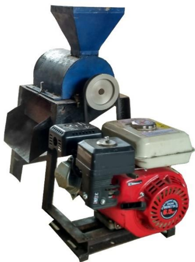
Gambar 6. Mesin Pengupas buah pinang kering
