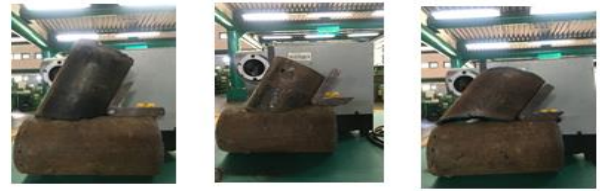
Gambar 8. Hasil pemotongan pada schedule pipa 10s a) jarak 5 mm, b) jarak 7 mm, dan c) jarak 10 mm
