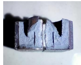
Gambar 8. Pengamatan Pola Patahan Baja AISI 1045 Hasil Tempering Temperatur 450°C
