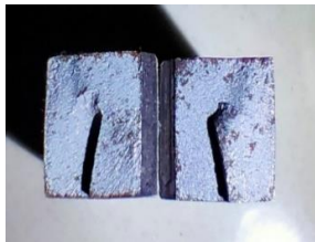
Gambar 6. Pengamatan Pola Patahan Baja AISI 1045 Hasil Quenching Temperatur 850°C
