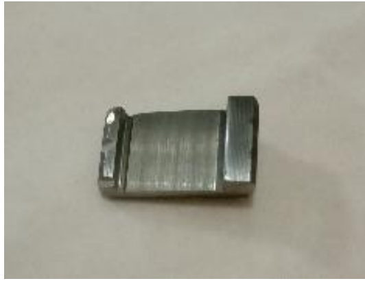
Gambar 4. Inner ring setelah dipotong
