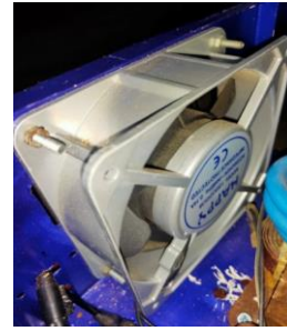
Gambar 5. Pemasangan kipas pendingin.
