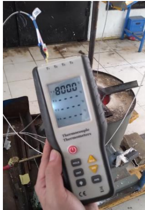
Gambar 2. Proses peleburan dan pengukuran temperatur logam cair
