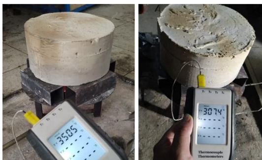
Gambar 3. Proses pre-heating pada cetakan
