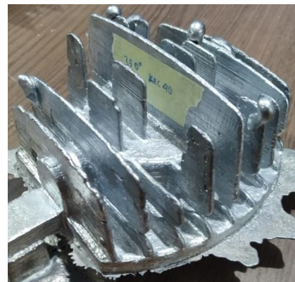
Gambar 12. Pre-heat 3000C kecepatan 40 rpm
