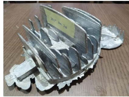
Gambar 10. Pre-heat 3500C kecepatan 20 rpm
