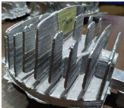
Gambar 8. Pre-heat 3000C kecepatan 30 rpm
