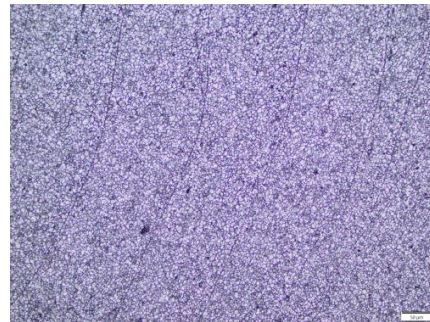
Gambar 8. Foto struktur mikro nugget zone spesimen 1500
