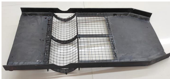
Gambar 6. Bentuk jaring perontok pada mekanisme perontok lada
