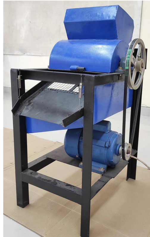
Gambar 7. Mesin perontok lada dengan modifikasi pada mekanisme perontok
