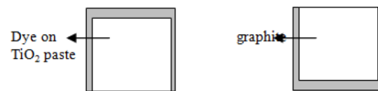
Gambar 2. Bagian konduktif pada kaca ITO untuk lapisan \text{TiO}_2 dan grafit
