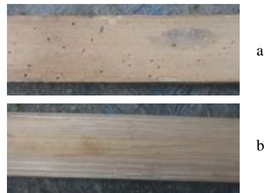
Gambar 4. Pengamatan sampel (a) tanpa perlakuan dan (b) perendaman air laut.
