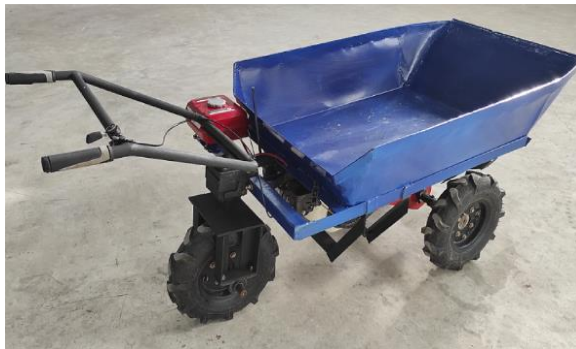
Gambar 4. Alat angkut TBS hasil rancang bangun [15]
