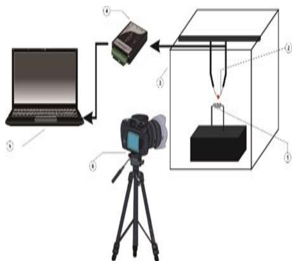
Gambar 1. Instalasi pembakaran droplet: (1) elemen pemanas (2) thermocouple (3) droplet (4) data logger (5) laptop dan (6) kamera berkecepatan tinggi
