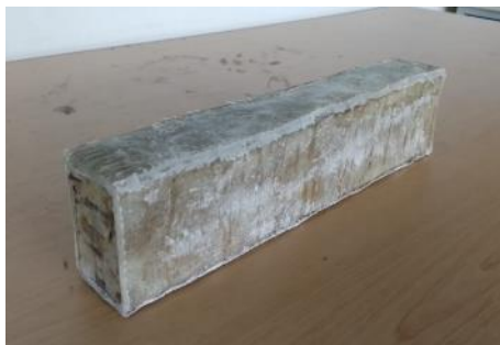
Gambar 3. Spesimen Kayu + FRP
