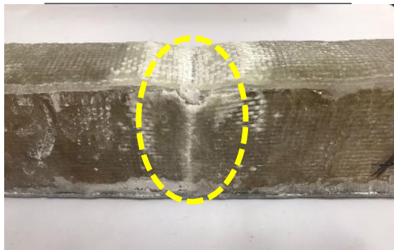
Gambar 10. Kerusakan pada Sepesimen A9
