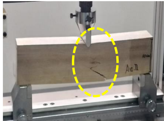
Gambar 8. Kerusakan Pada Spesimen A10
