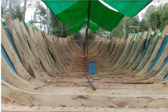
Gambar 1. Struktur Gading Kapal Kayu (Sumber : Dokumentasi Pribadi, 2022)
