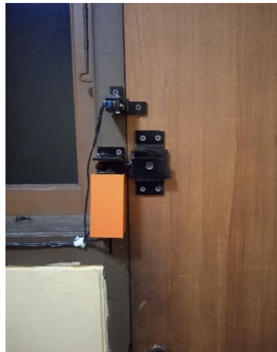
Gambar 10. Pemasangan model pengunci pada pintu satu daun
