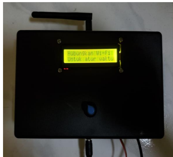
Gambar 7. Bentuk fisik unit kendali + data logging
