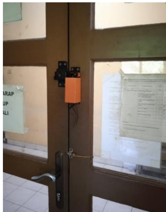
Gambar 11. Pemasangan model pengunci pada pintu dua daun
