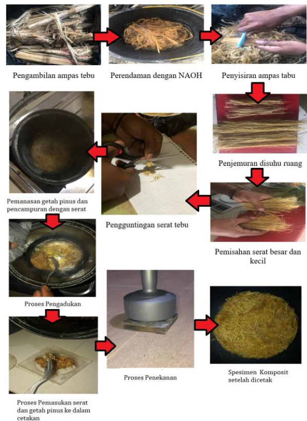
Gambar 3. Proses Penyiapan Serat hingga pembuatan Komposit
