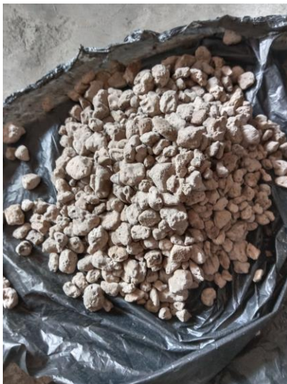
Gambar 10. Zeolit yang telah digunakan sebagai filter gasifikasi
