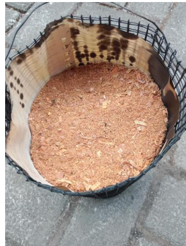
Gambar 8. Serbuk kayu yang telah digunakan sebagai filter gasifikasi
