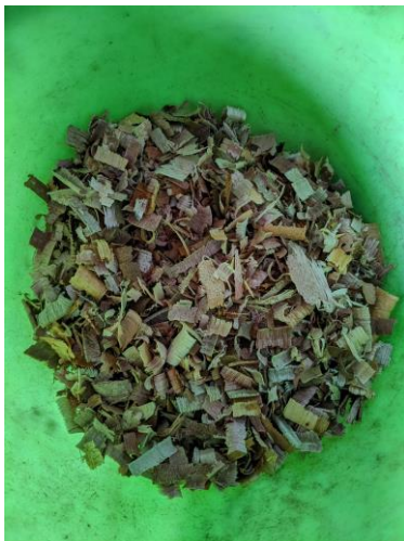
Gambar 6. Serutan kayu yang telah digunakan sebagai filter gasifikasi
