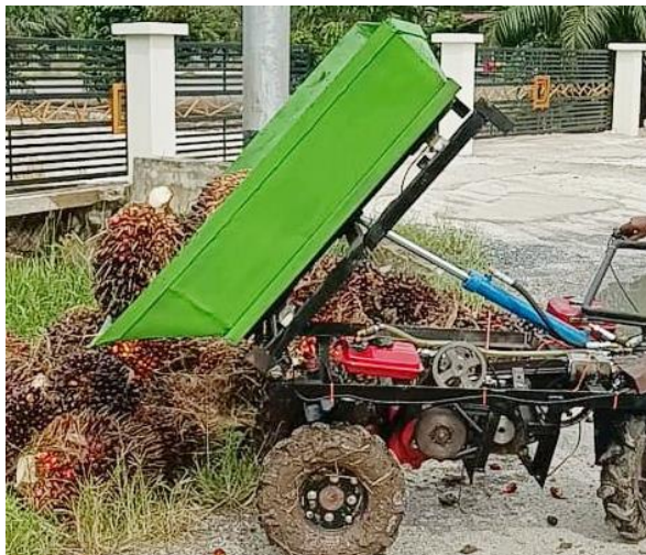
Gambar 7. Uji fungsional sistem pencurahan bahan
