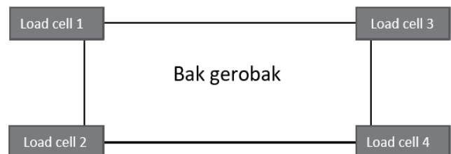
Gambar 3. Tampak atas posisi sensor load cell
