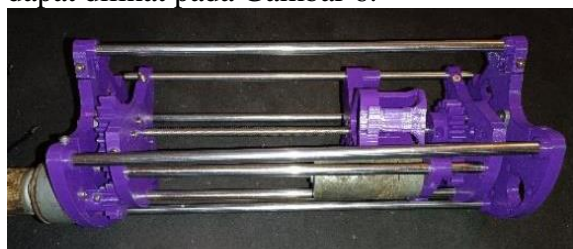
Gambar 6. Frame dari mekanisme Pitch dan rolling mass
