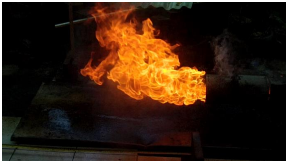
Gambar 4. Visualisasi Panjang Nyala Api Oli Tekanan 1 Bar Pada Mainjet 87,5, dengan Bukaan Valve 90°
