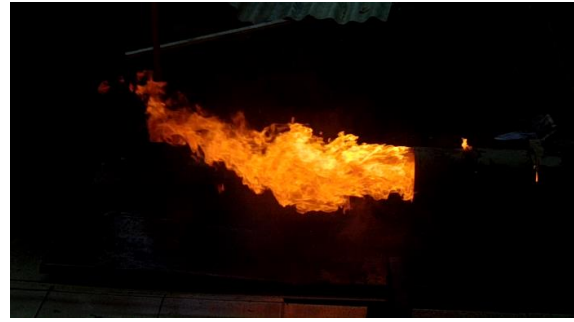
Gambar 7. Visualisasi Panjang Nyala Api Tekanan 4 Bar Pada Mainjet 87,5, dengan Bukaan Valve 45°
