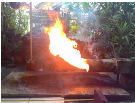
Gambar 9. Visualisasi Panjang Nyala Api Oli Tekanan 2 Bar pada Mainjet 95, dengan Bukaannya Valve 75°
