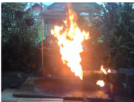
Gambar 11 Visualisasi Panjang Nyala Api Oli Tekanan 4 Bar pada Mainjet 95, dengan Bukaannya Valve 75°
