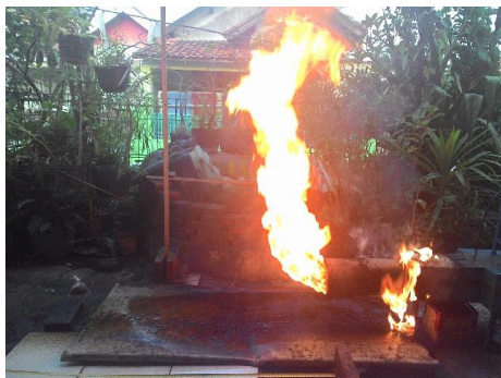
Gambar 6. Visualisasi Panjang Nyala Api Oli Tekanan 3 Bar Pada Mainjet 87,5, dengan Bukaan Valve 45°
