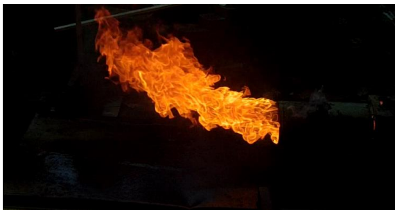
Gambar 5. Visualisasi Panjang Nyala Api Oli Tekanan 2 Bar Pada Mainjet 87,5, dengan Bukaan Valve 60°
