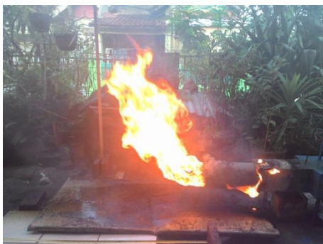
Gambar 10. Visualisasi Panjang Nyala Api Oli Tekanan 3 Bar pada Mainjet 95, dengan Bukaannya Valve 60°
