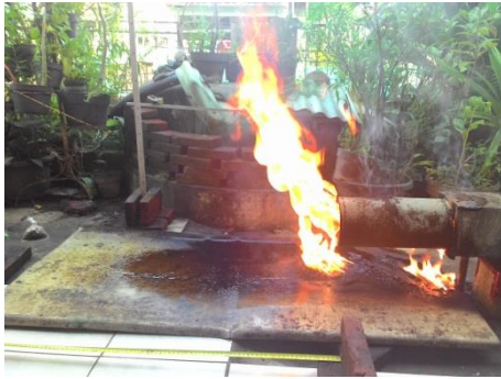
Gambar 8. Visualisasi Panjang Nyala Api Oli Tekanan 1 Bar pada Mainjet 95, dengan Bukaannya Valve 75°
