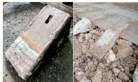
Gambar 4. Pengelasan dan produk bucket teeth
