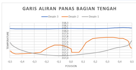
Gambar 37. Penarikan garis aliran panas dan data grafik penyebaran panas bagian tengah
