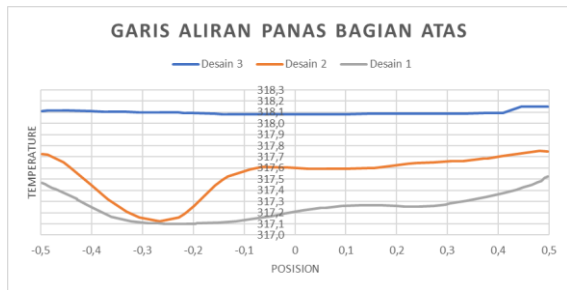
Gambar 26. Penarikan garis aliran panas dan data grafik penyebaran panas bagian atas
