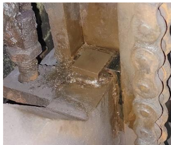
Gambar 8. Liner tipe baru yang terpasang pada Spindle Support
