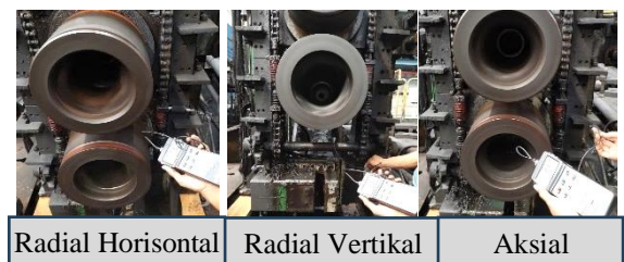
Gambar 2. Titik pengambilan data vibrasi spindle bawah
