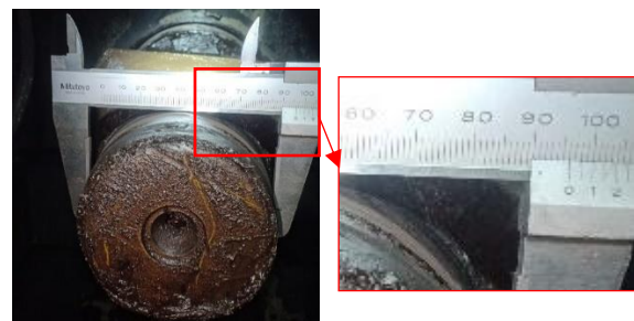
Gambar 9. Diameter roll (96mm) yang masuk ke dalam ring chock
