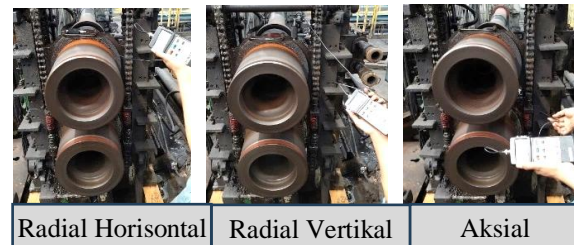
Gambar 1. Titik pengambilan data vibrasi spindle atas
