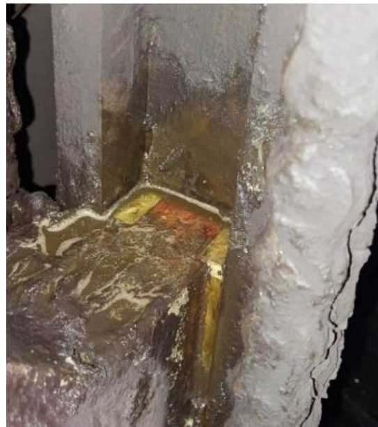
Gambar 7. Liner tipe lama yang terpasang pada Spindle Support
