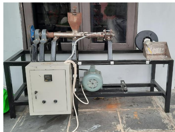
Gambar 2. Hasil Perancangan mesin ekstruder
