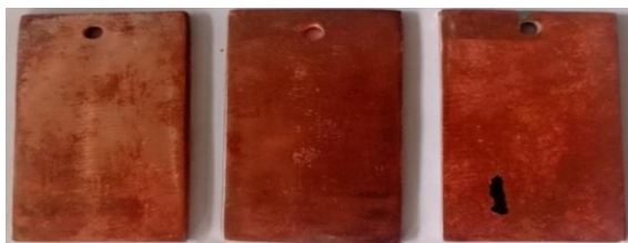
Gambar 4. Hasil elektroplating selama 5 menit
