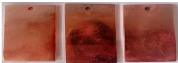
Gambar 6. Hasil elektroplating selama 15 menit
