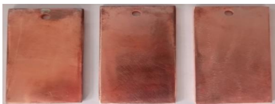
Gambar 5. Hasil elektroplating selama 10 menit
