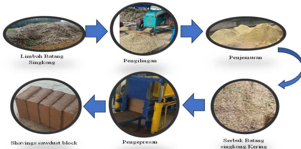
Gambar 1. Mekanisme pengolahan sampel bahan baku
