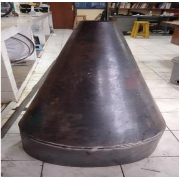
Gambar 8. Basin berbentuk kerucut yang dibuat.
